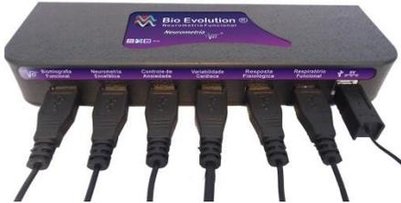
Os sensores são conectados de forma não invasiva e passam sinais para o computador através do microprocessador (unidade de codificador). O codificador analisa os sinais recebidos, digitaliza, codifica e transmite os dados para o computador, através do cabo USB, fornecendo máxima liberdade de movimento, fidelidade do sinal e isolamento elétrico para que se comunique com o software.
