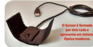
O Sensor é formado por dois Leds e apresenta um sistema Óptico moderno.
